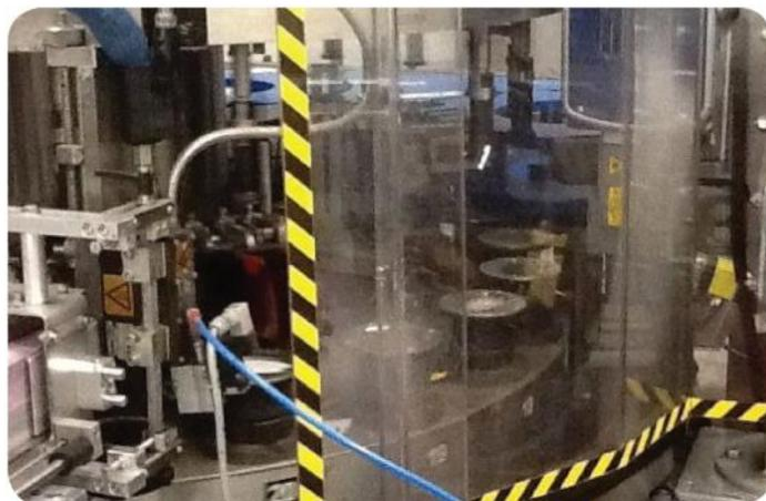
*Сканер DataMan300 захватывает изображение этикетки с разрешением, необходимым для надёжного считывания независимо от положения, качества или состояния кода.*
